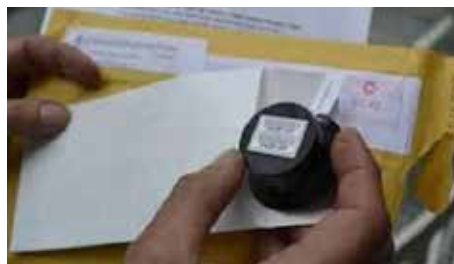
Appareil pour tester la concentration du radon (Photo : Archives jdv)
